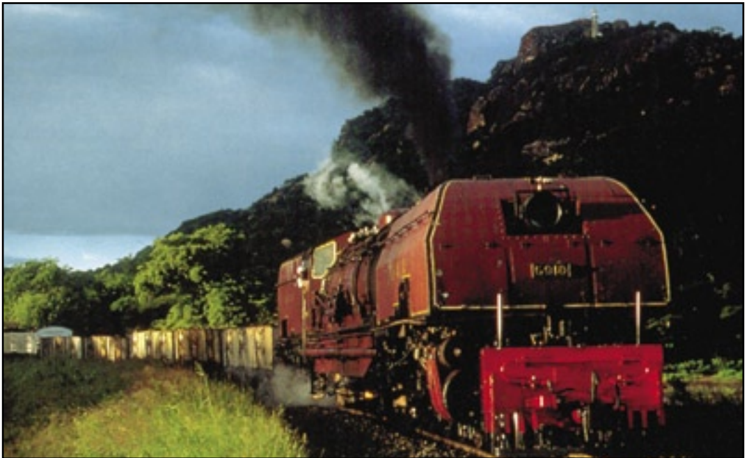
• Nella foto la locomotiva a vapore "Garratt" delle East African Railways (Kenia), che poteva raggiungere una velocità di 80 Km/h e uno sforzo di trazione di 38 t.
